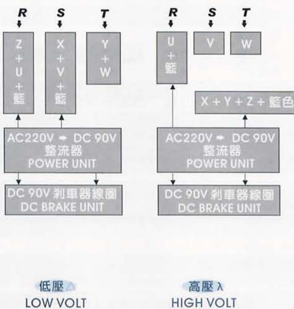
(e) 六條馬達電源線附直流剎車器 (SIX WIRES W/ DC BRAKE UNIT)
